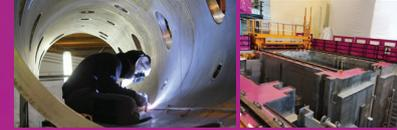
Fabrication d'un cryomodule pour le CEA
